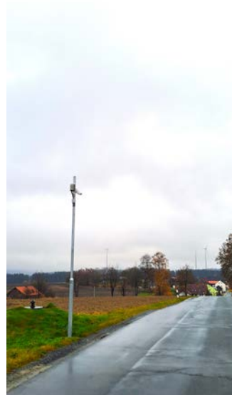
Die Sensoren ermitteln den Taupunkt, um die Glättegefahr besser einschätzen zu können – wie hier bei Biengarten.
